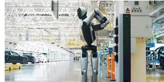
优必选 Walker S2 人形机器人，全球首款具备自主换电能力
