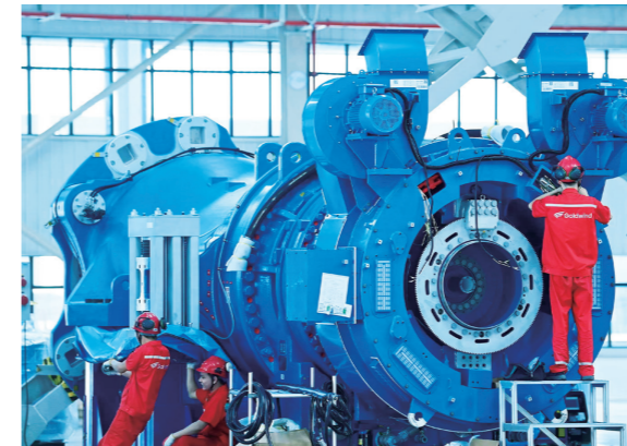
金风科技 GWH252-16MW 整机组装线
